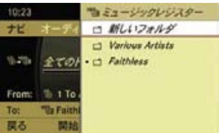
**i** 同じアーティストのトラックがすでにミュージックレジスターに録音されているときは、"新しいフォルダ" が選択できます。
