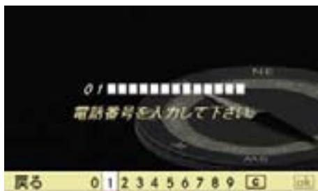
▶ コントロールダイヤルをまわすか、コントロールスティックを左右に倒して、数字を選択します。
