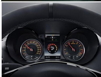
AMGトラクションコントロールの利点は、仮想  $\mu$  シミュレーターや制御装置が処理する様々なデータを利用して、状況を瞬時に予測できることです。駆動するリアホイールの最大許容スリップ量は、AMGトラクションコントロールの選択レベルに応じて計算されます。加速中にホイールスリップが上記レベルに達すると、AMGトラクションコントロールはこの許容量を超えないようにエンジン出力を調整します。このため、車体は設定されたスリップ量の中で加速を続けます。調整には AMG リミテッド・スリップ・デフの効果も含まれます。
