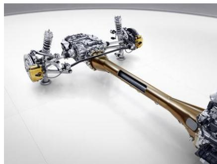
カーボンファイバー製トルクチューブは重量わずか 13.9kg と、すでに軽量化されている AMG GT のアルミニウム製に比べて約 40%も軽くなりました。このトルクチューブはトランスアクスル型ドライブレインの構造部品としてエンジンとトランスミッションを接続するもので、きわめて高い曲げ剛性とねじり剛性を備えています。ドライブレインをきわめてダイレクトに接続することができるため、運動性能や車両重量配分バランスの面でもメリットをもたらします。
