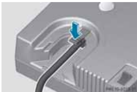
エアホースの取り外し
