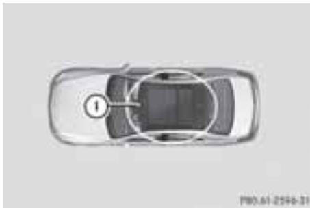
① 車内アンテナの検知範囲
